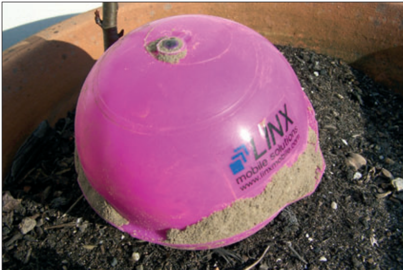
3-M markers zijn plastic bollen met een magneetspoel en een klein RFID-geheugen-chipje met een uniek nummer.
