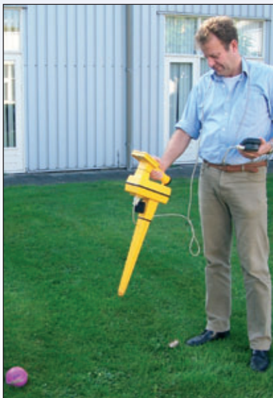
De LINX-oplossing bestaat uit een marker met een unieke ID, een locator en een handheld.
